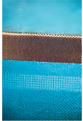
**Le carbone et le nid d'abeille de type Nomex<sup>®</sup>** utilisés pour le drapage des pièces composites renforcent leur résistance et leur assurent aussi une légèreté maximale. Résultat : le poids de l'avion, la consommation de carburant et les émissions de CO<sub>2</sub> sont réduits.
