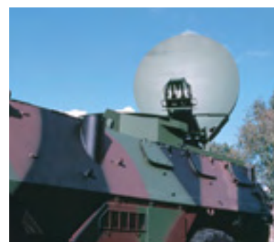
Satcom militaire (1,8 m) monté sur véhicule blindé (VAB)
