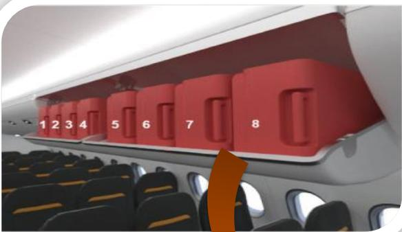
Premier coffre à bagages à pivot, permettant jusqu'à 60% de capacité supplémentaire de rangement avec un poids réduit et une ergonomie améliorée
